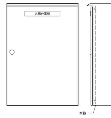
**共用分電盤 屋外露出型SUS製**
